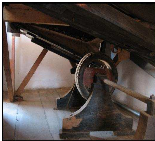
Figura 43 – Detalhe dos Foles e roldanas Fonte: Acervo fotográfico do autor..
